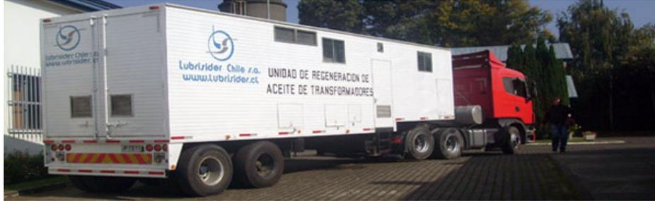
Lubrisider Chile S.A. dispone de equipos móviles diseñados específicamente para la regeneración "in situ" de aceites aislantes de transformadores en servicio o fuera de servicio, mediante la aplicación de una técnica totalmente ecológica y económicamente eficiente.
